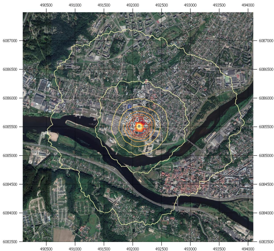
8 pav. Sumodeliuotų pažemio koncentracijų sklaidos žemėlapis. Azoto dioksido 1 valandos 99,8-o procentilio koncentracija ( \mu\text{g}/\text{m}^3 ).
