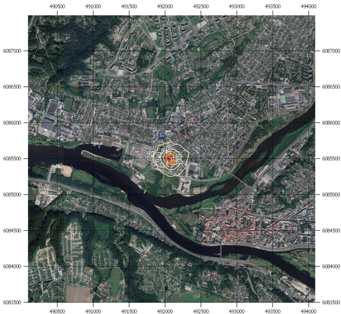
5 pav. Sumodeliuotų pažemio koncentracijų sklaidos žemėlapis. Amoniako 24 valandų 100-ojo procentilio koncentracija ( \mu\text{g}/\text{m}^3 ).
