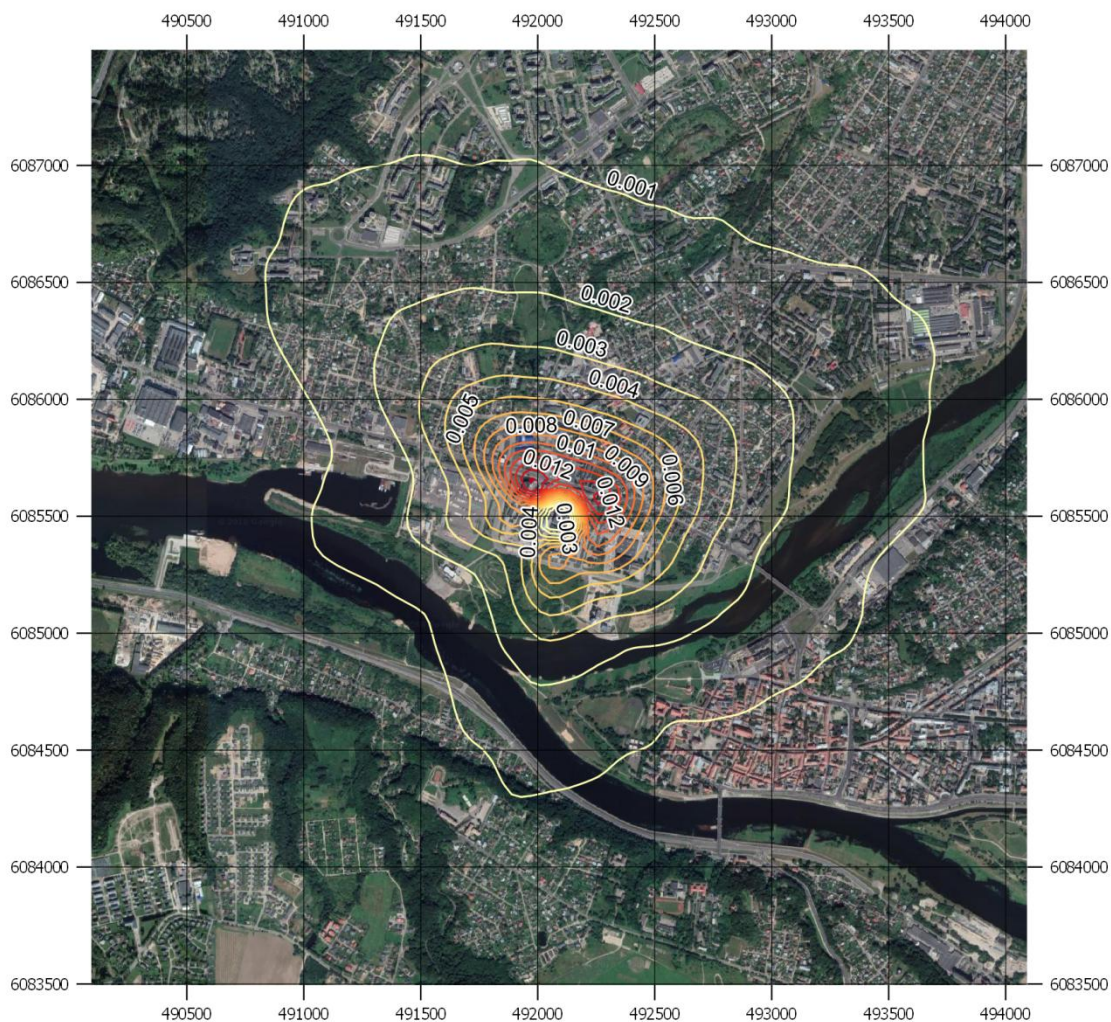
12 pav. Sumodeliuotų pažemio koncentracijų sklaidos žemėlapis. Kietųjų dalelių KD2,5 metų vidutinė koncentracija ( \mu\text{g}/\text{m}^3 ).
