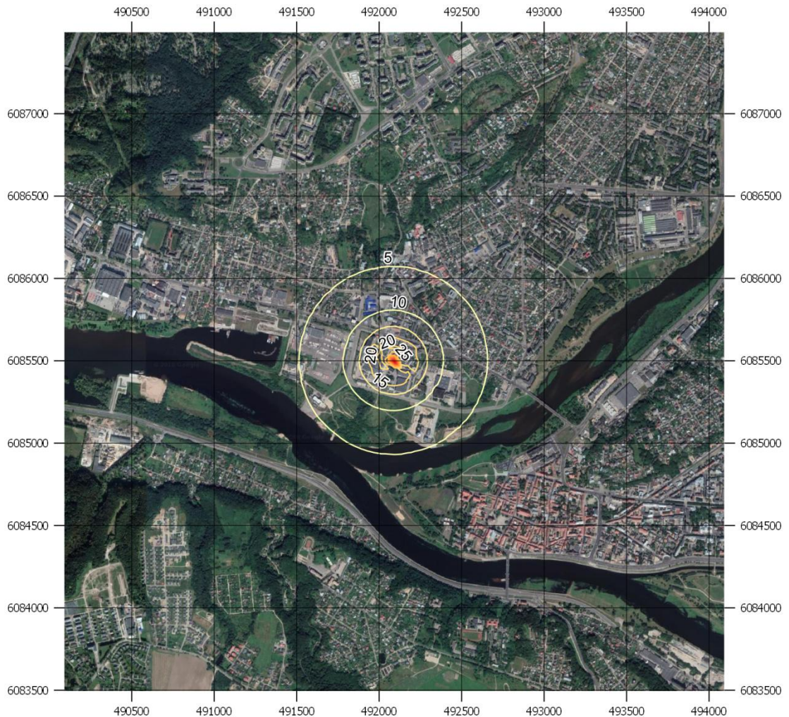
9 pav. Sumodeliuotų pažemio koncentracijų sklaidos žemėlapis. Etilacetato pusės valandos 100-ojo procentilio koncentracija ( \mu\text{g}/\text{m}^3 ).
